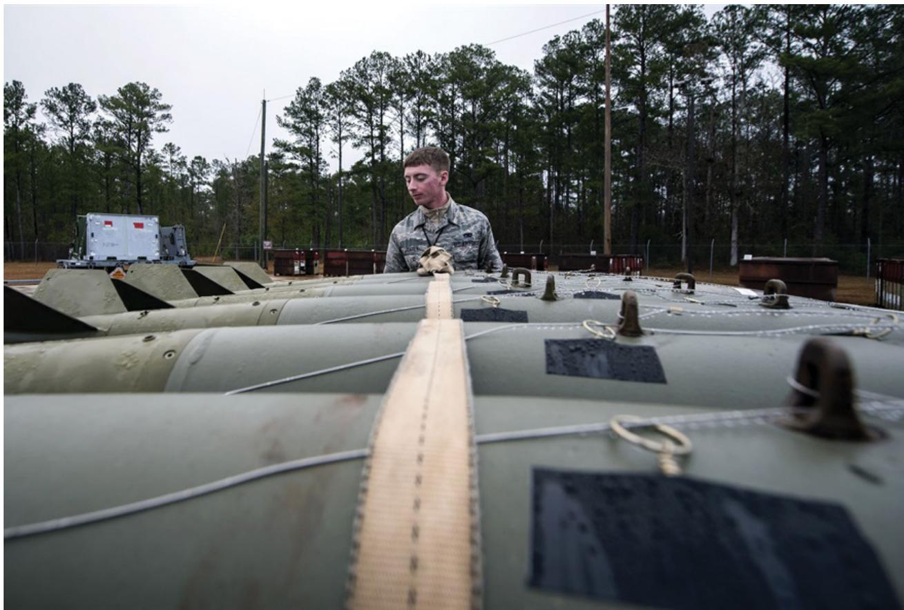
Um técnico de munições guiadas de precisão, do 23º Esquadrão de Manutenção, examina as munições de ataque direto Joint Direct Attack Munitions (JDAM), na Base da Força Aérea Moody, Geórgia, 11 Jan 18. Esse conjunto converte as bombas normais em munições "inteligentes" que são capazes de engajar autonomamente os alvos designados. (Cb Eugene Oliver, Força Aérea dos EUA)
