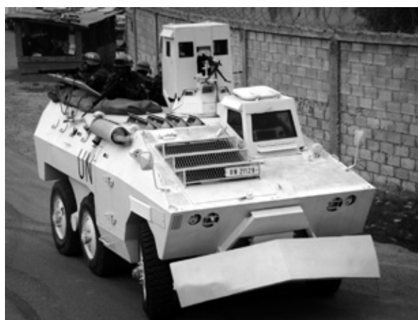
Viatura Urutu adaptada com a cabine de proteção blindada do motorista, a cabine de proteção balística do atirador da metralhadora e a lâmina frontal para remoção de obstáculos.
