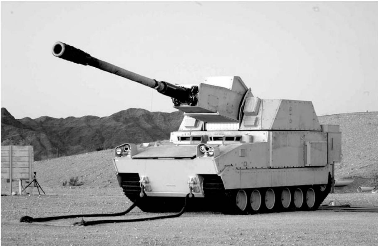
*O canhão sem-linha-de-visada autopropulsado XM1203 era um canhão móvel de 155 mm destinado a fornecer melhor reação e letalidade ao comandante da Unidade de Ação, como parte do projeto de Sistemas de Combate do Futuro do Exército dos EUA, Yuma, Arizona, 2009.*
