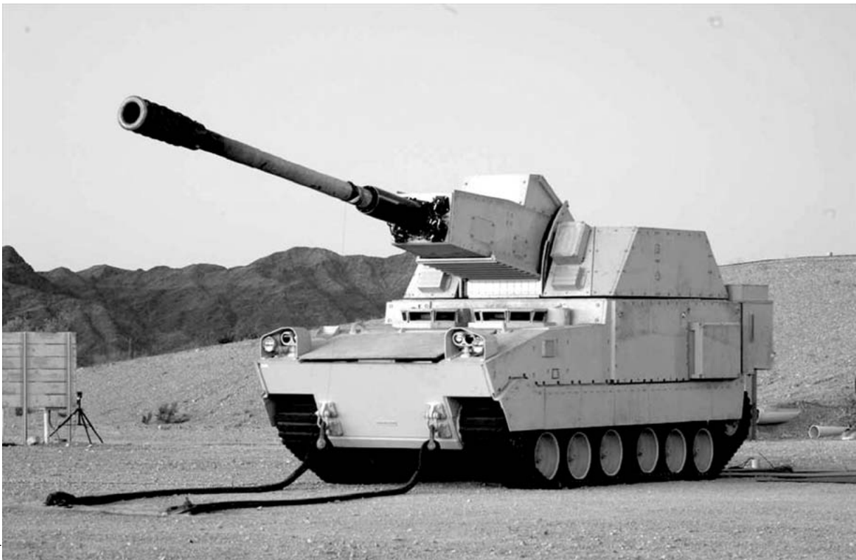
O canhão sem-linha-de-visada autopropulsado XM1203 era um canhão móvel de 155 mm destinado a fornecer melhor reação e letalidade ao comandante da Unidade de Ação, como parte do projeto de Sistemas de Combate do Futuro do Exército dos EUA, Yuma, Arizona, 2009.
