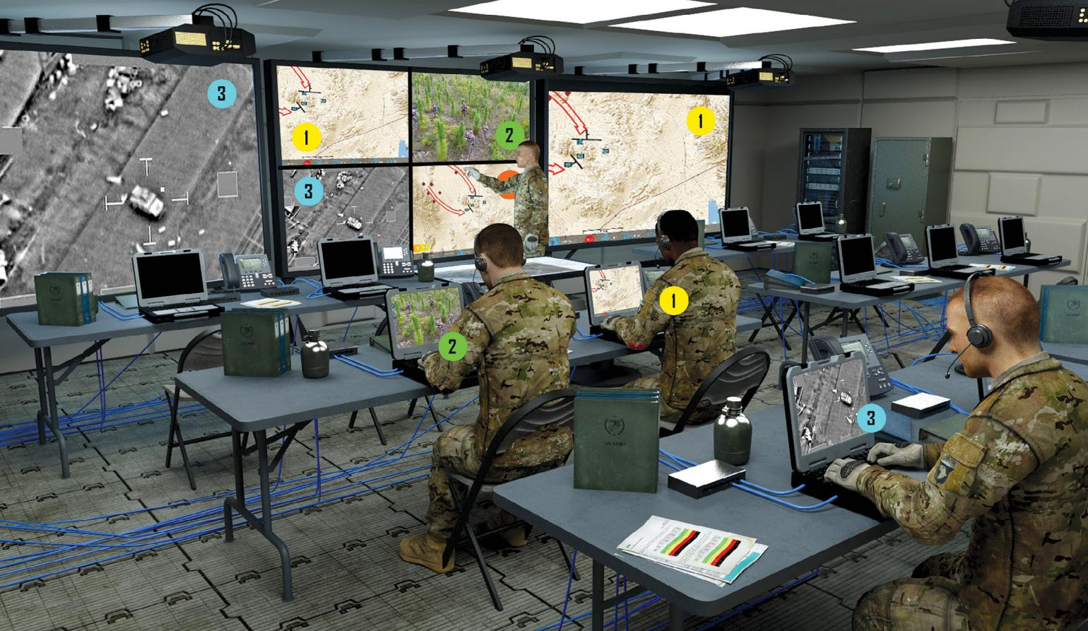
La aplicación de visualización digital, o DVA, proporciona al Ejército una solución de conmutación de vídeo basada en software y permite al personal del puesto de mando conectarse a la red de área local para compartir toda o parte de su pantalla con otras personas o en el sistema de visualización más grande de puesto de mando. (Simulación de foto cortesía del Ejército de EUA)
