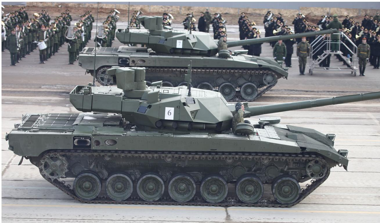
El tanque T-14 es un carro de combate ruso de última generación basado en la plataforma Armata. La dotación del T-14 incluye un cañón de ánima lisa de 125 mm 2A82 y hasta 40 municiones de uso variado, ametralladoras y miras panorámicas para disparar sobre la marcha. (Foto: Vitaly V. Kuzmin; Wikimedia Commons, [CC BY-SA 3.0](https://commons.wikimedia.org/wiki/File:T-14_Armata_tank.jpg))
