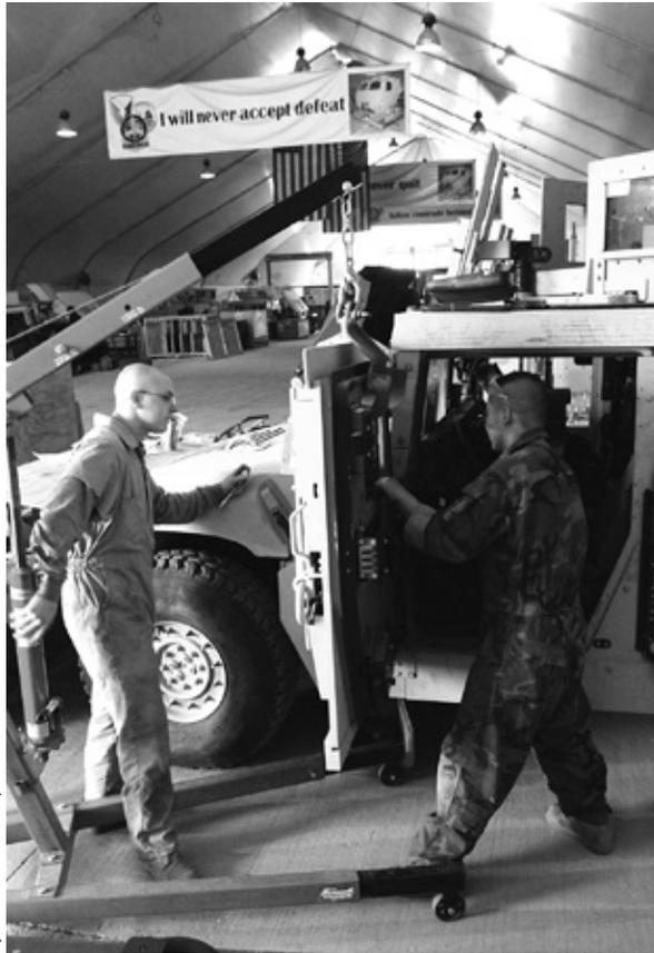
*Soldado Joshua Bullard y Sargento Kang Hoon Lee, mecánicos del 122º Batallón de Apoyo de Aviación de la 82ª Brigada de Aviación de Combate, usan un montacargas para montar una puerta de blindaje modificada en un vehículo HMMWV, 25 de mayo de 2007.*
