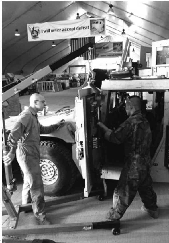
Soldado Joshua Bullard y Sargento Kang Hoon Lee, mecánicos del 122º Batallón de Apoyo de Aviación de la 82ª Brigada de Aviación de Combate, usan un montacargas para montar una puerta de blindaje modificada en un vehículo HMMWV, 25 de mayo de 2007.
