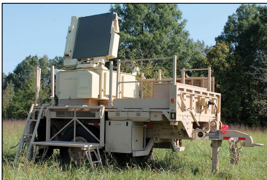
El Sistema de Radar Mejorado AN/MPQ-64 A3 Sentinel es el único radar de defensa anti-aérea que proporciona la cobertura de 360 grados en el inventario del Ejército. Tiene un radar de antenas en fase tridimensional de banda X que proporciona un alcance instrumentado de setenta y cinco kilómetros.
