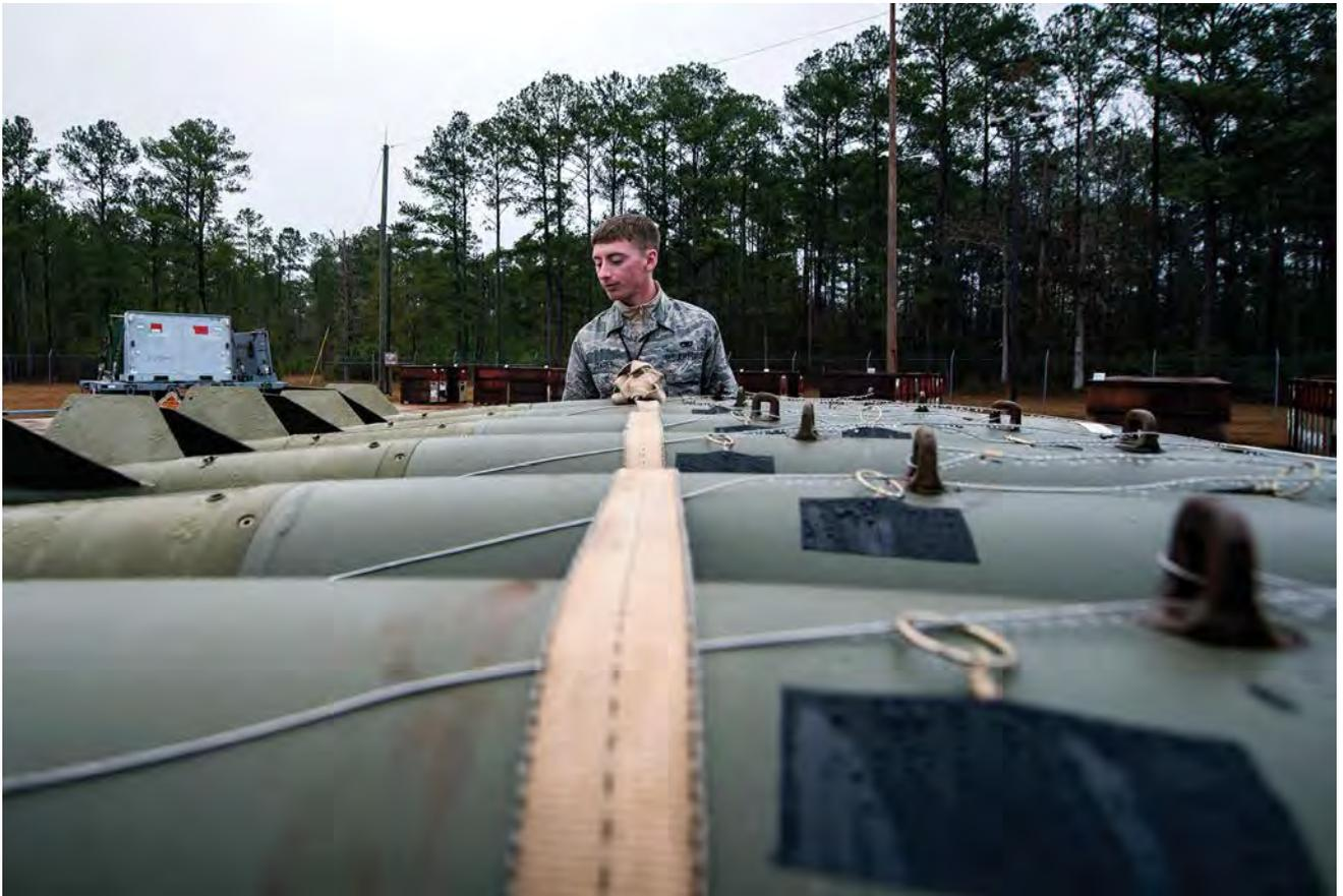
El soldado de primera clase Colten Carey, técnico de municiones guiadas de precisión del 23° Escuadrón de Mantenimiento, examina bombas con los kits de navegación JDAM el 11 de enero de 2018 en la base aérea Moody, en Georgia. El kit de navegación JDAM convierte las bombas estándares en municiones «inteligentes», capaces de interceptar de forma autónoma blancos designados. (Foto: Soldado Eugene Oliver, Fuerza Aérea de EUA)
