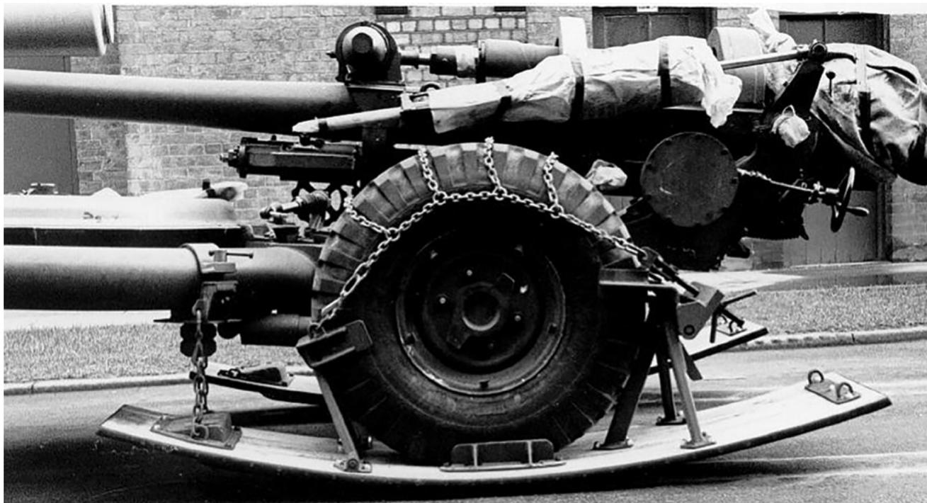
Esquíes son instalados en una pieza de artillería durante un estudio de movilidad ártica del Centro de Pruebas de Regiones Frías en 1987. Estos esquíes resultaron laboriosos de instalar, estaban mal diseñados y no mejoraron significativamente la movilidad del obús. (Foto cortesía del Centro de Pruebas de Regiones Frías)
