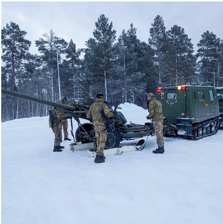
Soldados del 29.º Regimiento de Comandos (R. U.) de la Artillería Real fijan unos esquis a una pieza de artillería antes de remolcarla detrás de un remolcador motorizado de oruga con capacidad para desplazarse sobre la nieve. Esta configuración podría ser utilizada por los batallones de artillería del Ártico de EUA para aumentar la movilidad. (Foto cortesía del 29.º Regimiento de Comandos de la Artillería Real)
