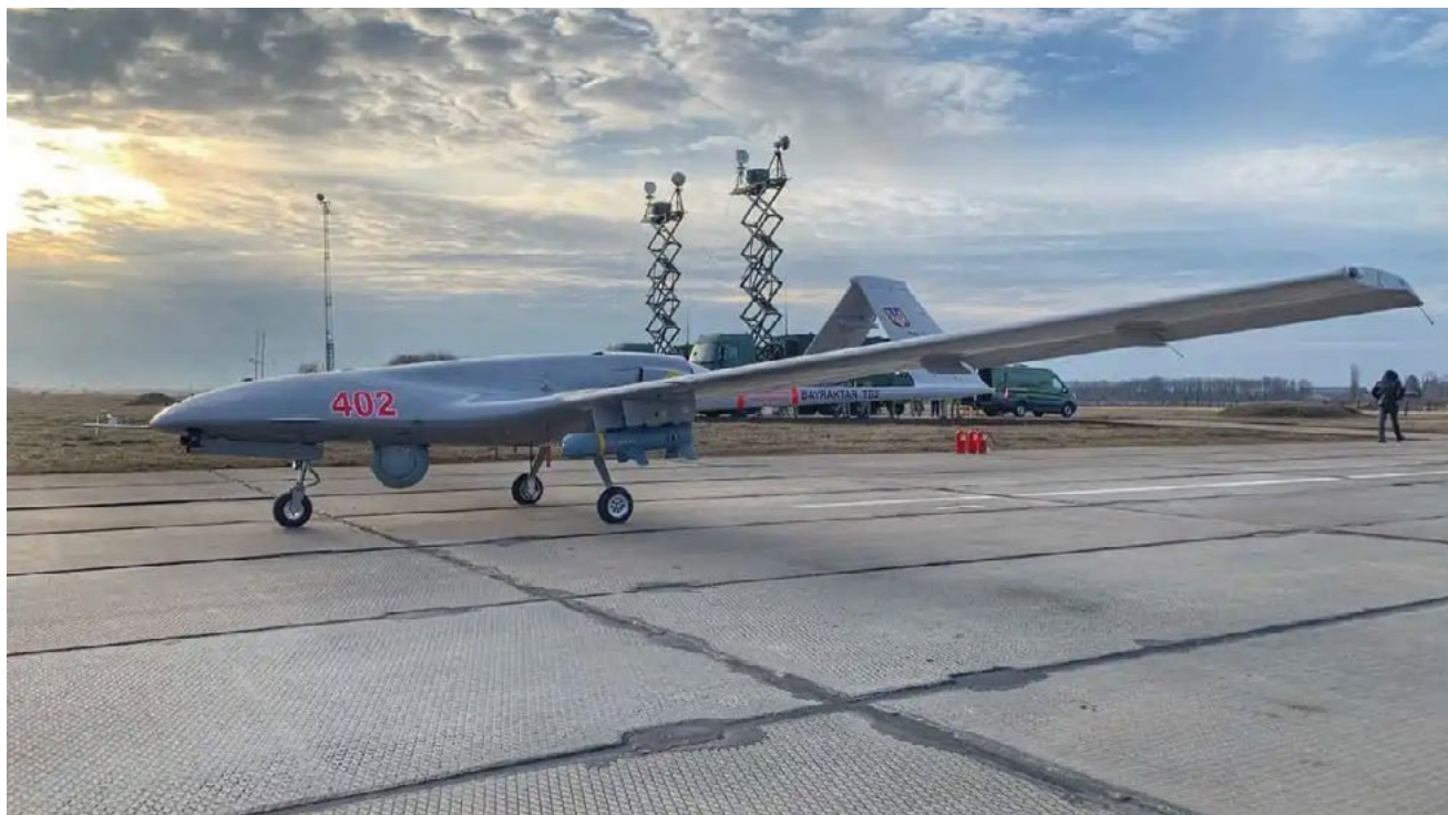
Un drone tipo Bayraktar TB2 de las fuerza aérea de ucraniana armado con una bomba guiada MAM-L Smart Micro Muniton; al fondo se ven dos estaciones de control terrestre. (Foto cortesía del Ministerio de Defensa de Ucrania vía Wikimedia Commons)
