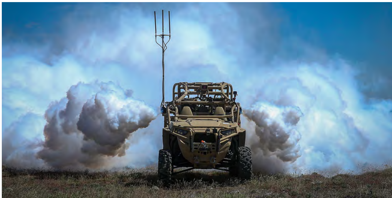
Un dispositivo activado autónomamente suelta vapor para oscurecer la parte trasera de un vehículo UTV en el Centro de Entrenamiento de Yakima, en el estado de Washington, el 26 de abril de 2019, durante el Robotic Complex Breach Concept, un evento militar centrado en las tecnologías autónomas. (Foto: Cabo interino Nathaniel Hamilton, Cuerpo de Infantería de Marina de Estados Unidos)
